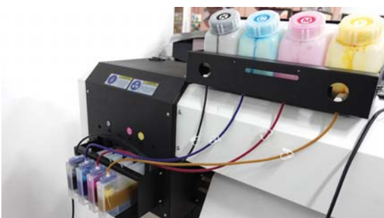
В рулонных принтерах своя система непрерывной подачи чернил.
