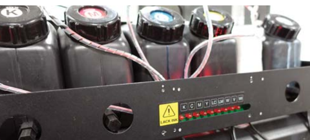
Об израсходовании чернил сигнализируют световые индикаторы.
