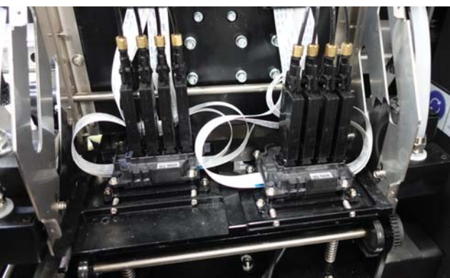
В UV-740D используются две четырехканальные печатающие головки Epson i1600.
