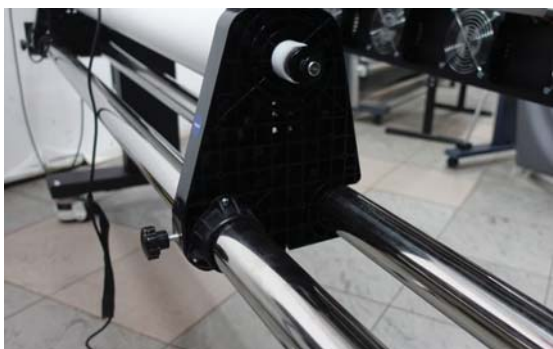
Рулонные принтеры комплектуются усиленными балками, которые позволяют устанавливать рулоны весом до 100 кг.
