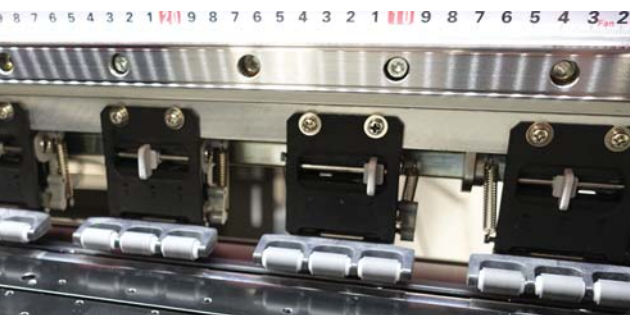
Прижимные ролики можно регулировать независимо друг от друга.
