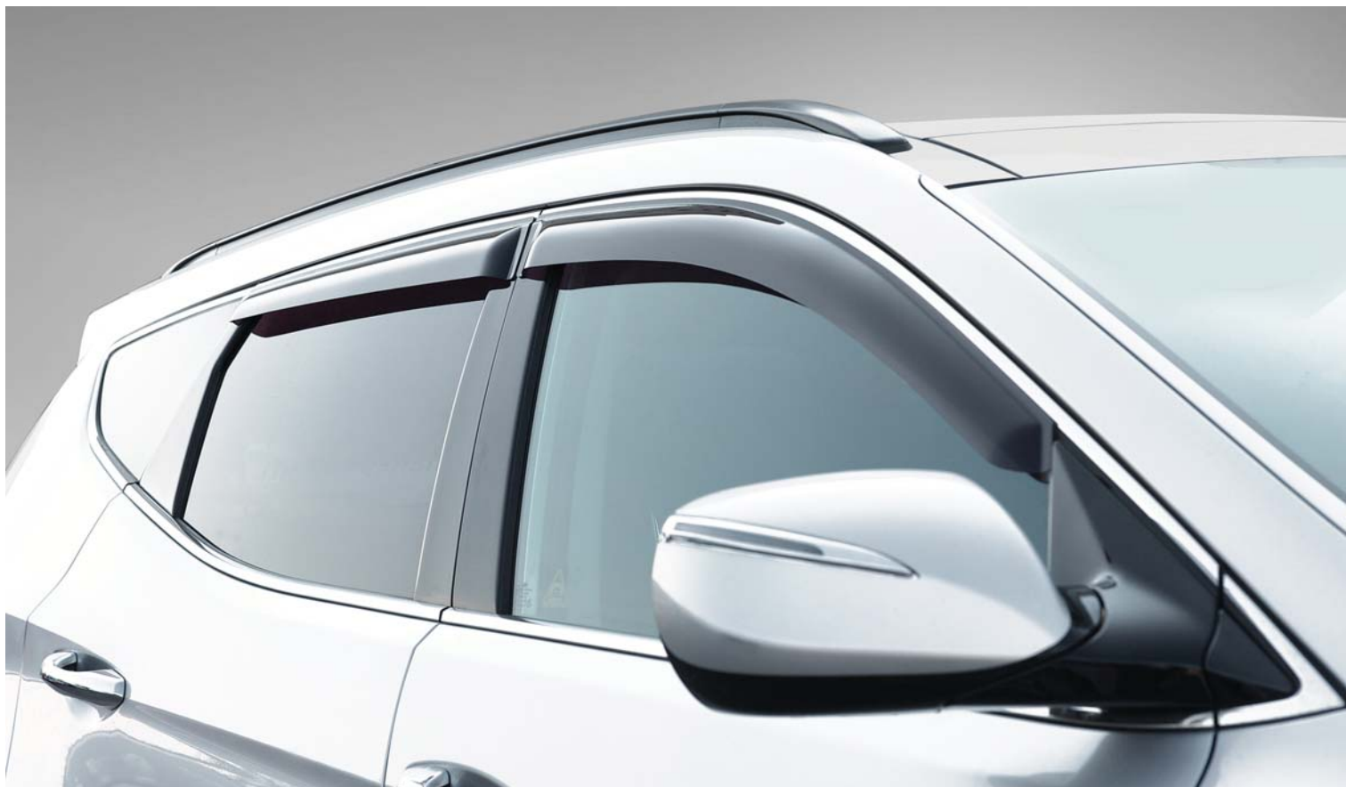
Плексигласовые дефлекторы окон и капота для легковых и грузовых машин не меняют цвет десятилетиями, выдерживают морозы, соль и осадки. На фото — одна из разновидностей дефлекторов, производимых в РФ из дымчатых листов завода ДЕСТЕК.
