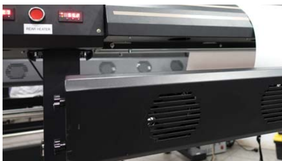
Стол с подогревом и навесной вентилятор осуществляют сушку изображения.
