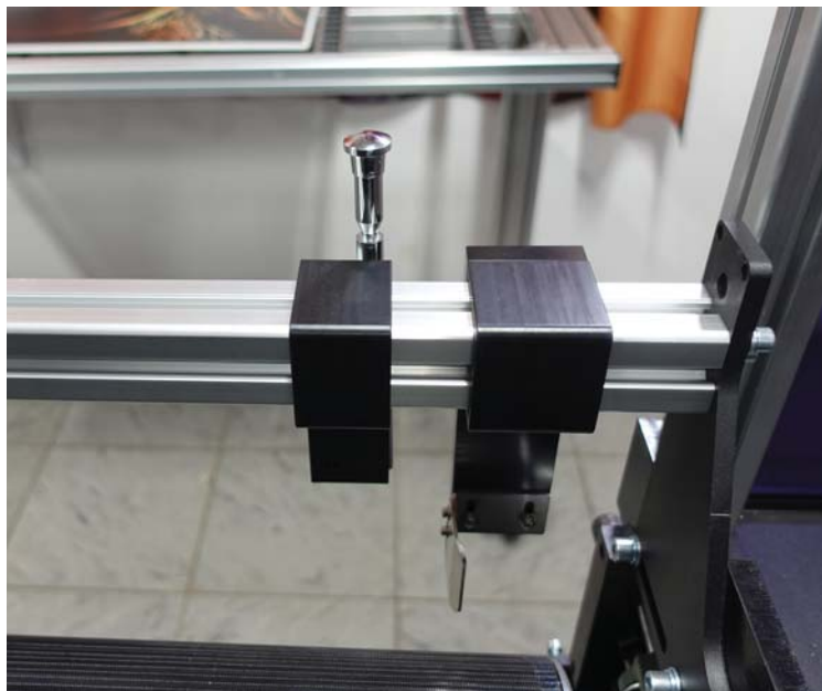
Система упоров позволяет положить лист ровно без перекосов и смещения.
