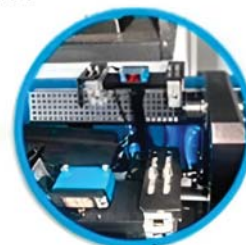
СИСТЕМА УДАЛЕНИЯ ЧЕРНИЛЬНОЙ ПЫЛИ ИЗ ЗОНЫ ПЕЧАТИ
